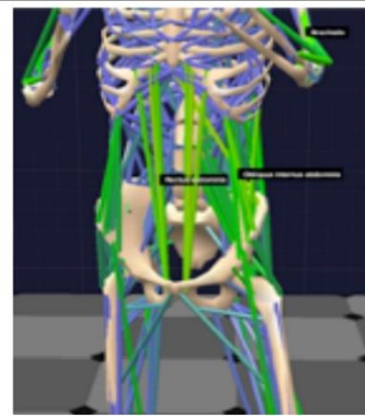
Figura 7-5. Análisis dinámico en los músculos abdominal, oblicuo y braquial (inferior izquierda) junto a su representación (inferior derecha) en el tiempo 1,4s marcado con una línea roja en las gráficas
